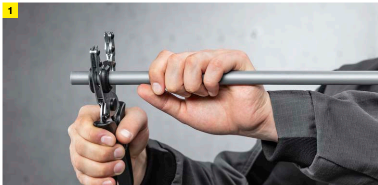
Rohr ablängen.
